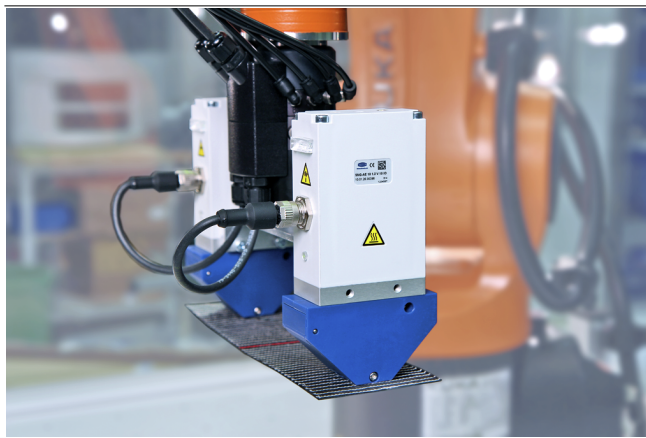
Nadelgreifer SNGi-AE bei der Handhabung von Composite-Textilien
